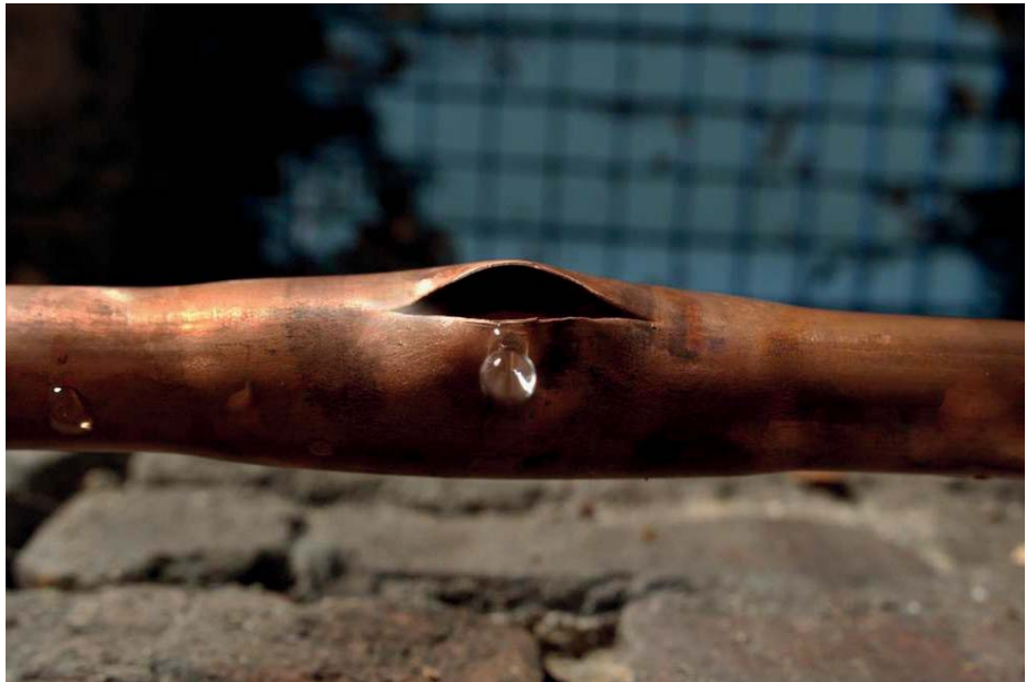
↑ Wasserrohr: Ein geplatztes Wasserrohr kann zu erheblichen Schäden am Gebäude führen. Wenn es schlecht läuft, müssen Putz und Mauerwerk großflächig weichen, um die Leckage zu finden.
